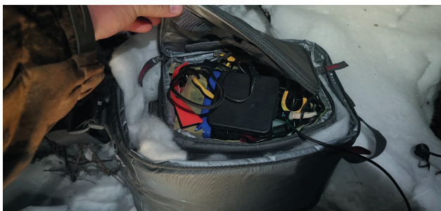
Рис. 6. Утеплённая станция зимой, окрестности Бужаниново
