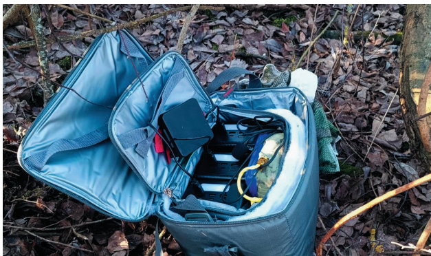
Рис. 3. Станция для полевой установки на 10,5 суток, готовая к работе и заморозкам
